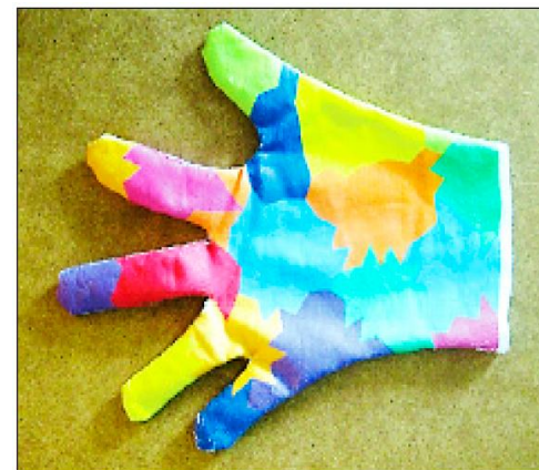
Пример перчатки, используемой для распознавания жестов руки при помощи камеры
